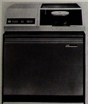
Mehrere dieser Magnetplattenspeicher IBM 2311 ermöglichen in Verbindung mit dem Hauptspeicher des Systems/360 Modell 40 den Zugriff auf 58 Millionen gespeicherten Zeichen
