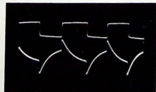
Bild 24. Starke Dachschräge bei sehr kleinem RC-Glied; obere Kurve: Originalschwingung, untere Kurve: verzerrte Schwingung
